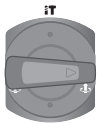
ตำแหน่ง Vario-Lock สำหรับปรับตำแหน่ง สกัด
